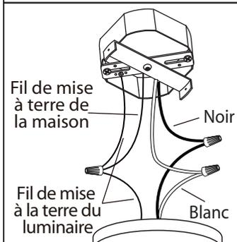
3. Branchez les fils de la mise a terre (cuivre nu ou vert) de votre montage au fil de la mise a terre (cuivre nu ou vert) ou vis de la mise a terre dans la boîte électrique. Posez le fil noir (ou fil ayant un écriteau) de la fixture au fil noir dans la boîte électrique et posez le fil blanc de la fixture au fil blanc dans la boîte.
