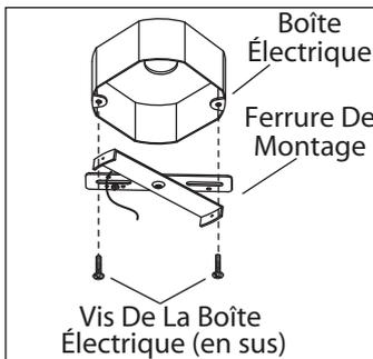
1. Posez la ferrure d'installation à la boîte de sortie électrique à l'aide des vis de la boîte (en sus).
