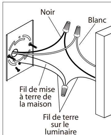
3. Branchez les fils de la mise a terre (cuivre nu ou vert) de votre montage au fil de la mise a terre (cuivre nu ou vert) ou vis de la mise a terre dans la boîte électrique. Posez le fil noir de la fixture au fil noir dans la boîte électrique et posez le fil blanc de la fixture au fil blanc dans la boîte.
