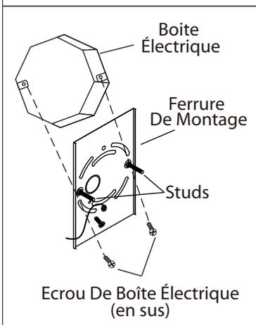
2. Posez la ferrure d'installation à la boîte de sortie électrique à l'aide des vis de la boîte (en sus). Assurez-vous que les goujons de la ferrure d'installation font face vers l'extérieur de la boîte électrique.
