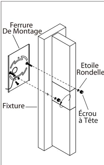
1. Retirez les braquettés de support du luminaire en dévissant les 2 écrous.
