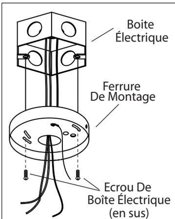
1. Posez la ferrure de montage à la boîte électrique à l'aide des vis (en sus) de la boîte électrique.
