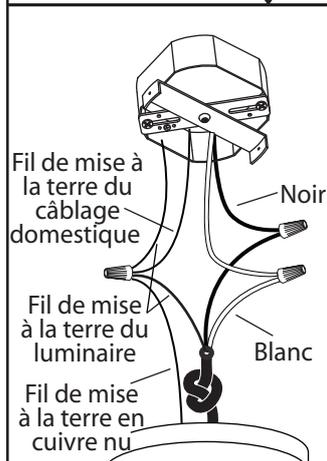
3. Branchez les fils de la mise a terre (cuivre nu ou vert) de votre montage au fil de la mise a terre (cuivre nu ou vert) ou vis de la mise a terre dans la boîte électrique. Posez le fil noir de la fixture au fil noir dans la boîte électrique et posez le fil blanc de la fixture au fil blanc dans la boîte.
