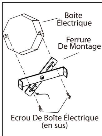
1. Posez la ferrure de montage à la boîte électrique à l'aide des vis de la boîte électrique (en sus).
