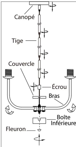
1. Répandez les bras également. Serrez la boîte du bas avec le fleuron contre le bout fileté. Resserrez le couvercle contre la structure avec l'écrou.
